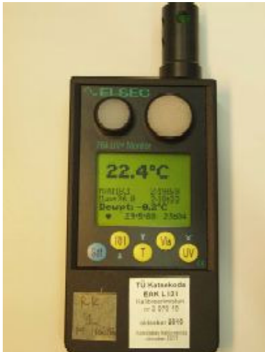
Рис.: Логер ELSEC 764 UV+Monitor – Логер, который показывает и периодически записывает в своей памяти данные о температуре воздуха, относительной влажности, освещенности и интенсивности УФ-излучения.
