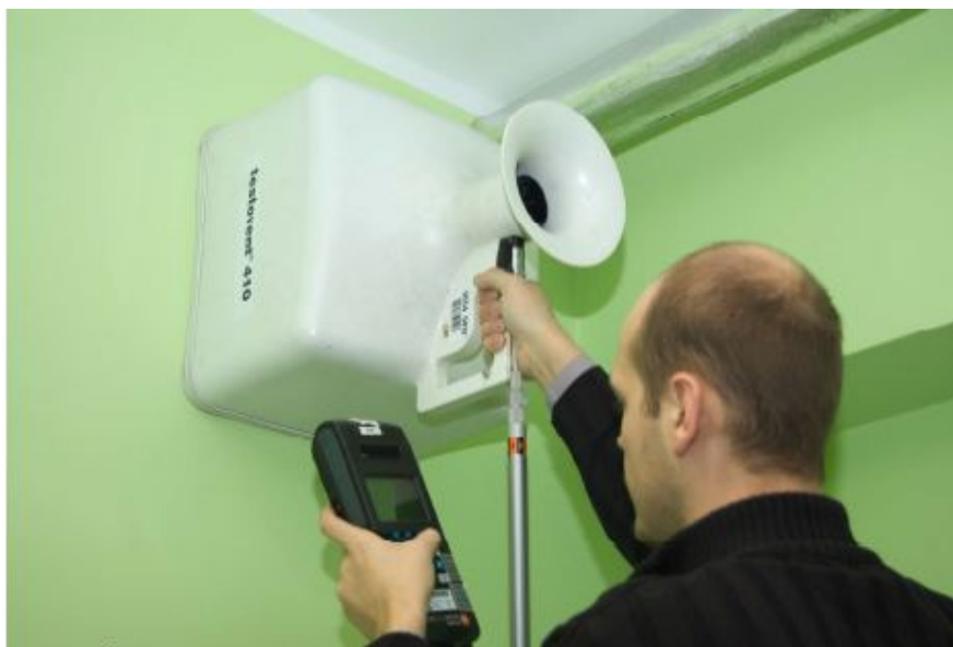
Рис.: Измерение потока воздуха при помощи устройства Testovent 410, размещенного на плафоне.
