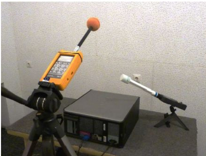
Рис.: Устройства для измерения электромагнитных полей Narda EMR-300 (слева) и Chauvin Arnoux CA 43
