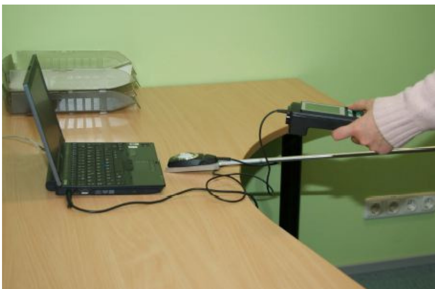
Рис.: Измерение освещенности с использованием люксметра Testo 545
