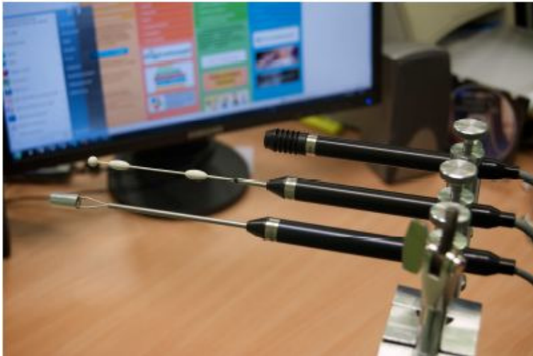
Рис.: Измерение параметров микроклимата с использованием трех сенсоров (температура воздуха, скорость движения воздуха, относительная влажность воздуха)
